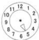
\* 製造年の最後の2つの数字はこの場所に表示して良い。その場合、時計円がUN設計型式マークに隣接して表示されている場合、マーク内のUN設計型式西暦年の表示は省略できる。ただし、時計円がUN設計型式マークに隣接して表示されていない場合は、マーク内と時計円内の西暦年の2桁は同一でなければならない。
